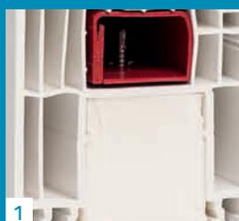
1 Hochdämmendes 6-Kammer-Thermo-Mitteldichtungssystem mit 70 mm Bautiefe. Stabilisierung mit Calcium/Zink statt mit Blei, vollständige Recyclingfähigkeit (Kömmerring Greenline)
