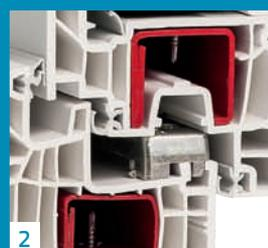
2 Drei Dichtungsebenen mit zentral angeordneter Mitteldichtung und stabilem doppelwandigem Mittelsteg für sicheren Schlagregenschutz und dauerhafte Winddichtigkeit.
